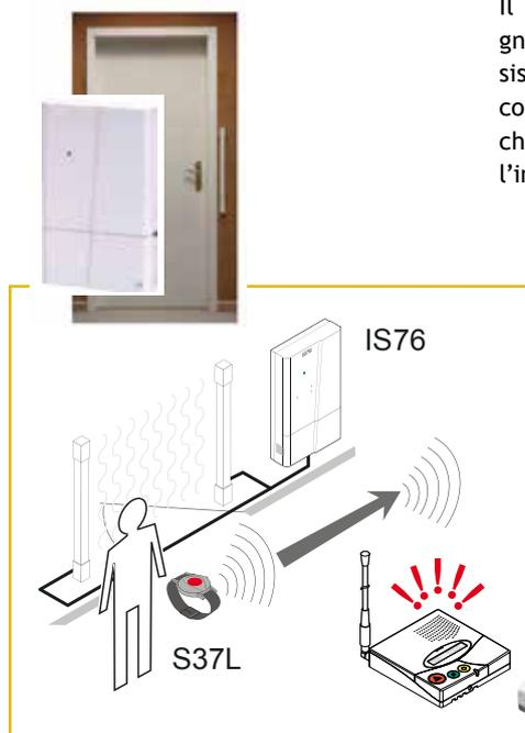
Schema di funzionamento del sistema Localizza con segnalatore ad antenna IS76 e unità master NurseCall
