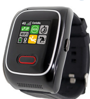
ALLERTO Watch trasmette allarmi via GSM (con nanoSIM) o Wifi. È resistente, leggero, indossabile anche a clip/gancio/ al braccio/al collo con gli accessori opzionali Smart-fix.
